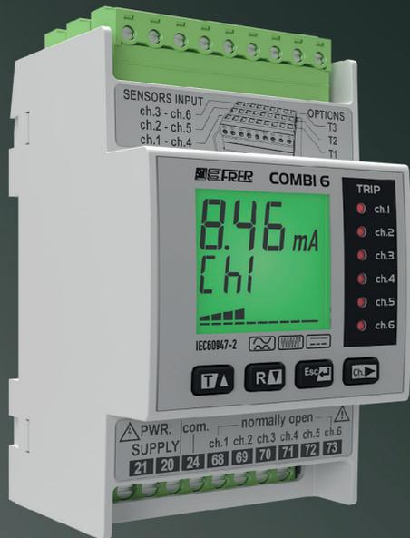
Il relè differenziale di terra Multicanale è stato progettato per il monitoraggio e protezione fino a 6 linee indipendenti. Un unico strumento di soli 3 moduli DIN permette una notevole ottimizzazione degli ingombri e dei tempi di cablaggio, grazie anche alla presenza di morsettiere estraibili per le connessioni. I 4 Tasti frontali ne consentono una programmazione immediata, ulteriormente semplificata dalla funzione copia/incolla presente nelle impostazioni.
