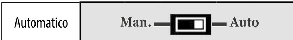
Il ripristino Manuale si può effettuare in maniera Locale premendo il tasto RESET o in maniera Esterna tramite un pulsante esterno collegato ai morsetti EXT RESET (87-88 isolata per modello \_E o \_2 oppure 87-22 non isolata per modello \_S).
