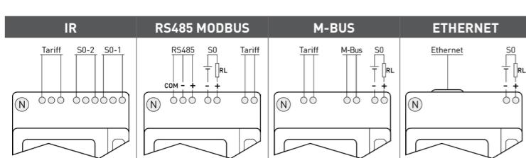
Il dispositivo comunica solo se almeno 2 fasi di tensione sono collegate. I valori di default sono quelli definiti nella norma EN 13757.
