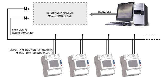
Il dispositivo comunica solo se almeno 2 fasi di tensione sono collegate. I valori di default sono quelli definiti nella norma EN 13757.
