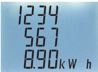
Energia attiva di sistema (Unico Numero espresso su 3 righe. Nell'esempio illustrato il conteggio corrisponde a 12345678,90kWh)
