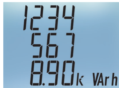
Energia reattiva di sistema (Unico Numero espresso su 3 righe. Nell'esempio illustrato il conteggio corrisponde a 12345678,90kvarh)
