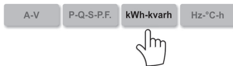
Energia reattiva di sistema (Unico Numero espresso su 3 righe. Nell'esempio illustrato il conteggio corrisponde a 12345678,90kvarh)
