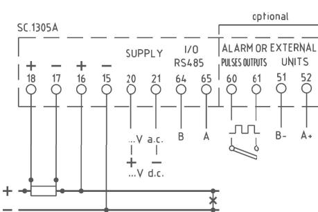
con derivatore su polo positivo / with shunt on positive polarity
