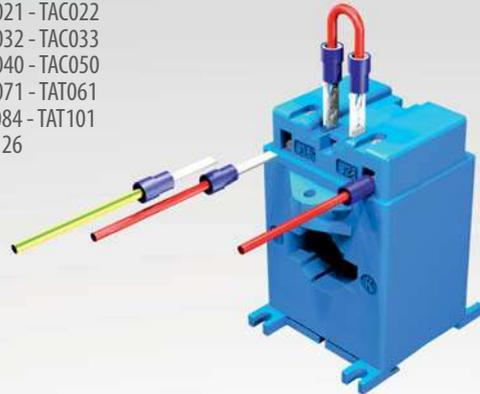
Collegamento secondario per i modelli con terminali integrati (IP20), provvisti di morsetti a vite per cavi di sez. max.6mm<sup>2</sup> e di connessione con faston maschio 6,3x0,8mm per il cortocircuito.
