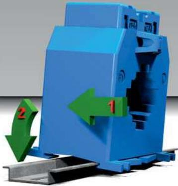
Fissaggio su barra DIN EN 50022. Non è necessario l'utilizzo di attrezzi e deve essere effettuato, come evidenziato dalle frecce, inserendo prima il lato con l'aggancio elastico e poi ruotando il trasformatore fino a bloccaggio avvenuto. Procedere inversamente per lo smontaggio.
